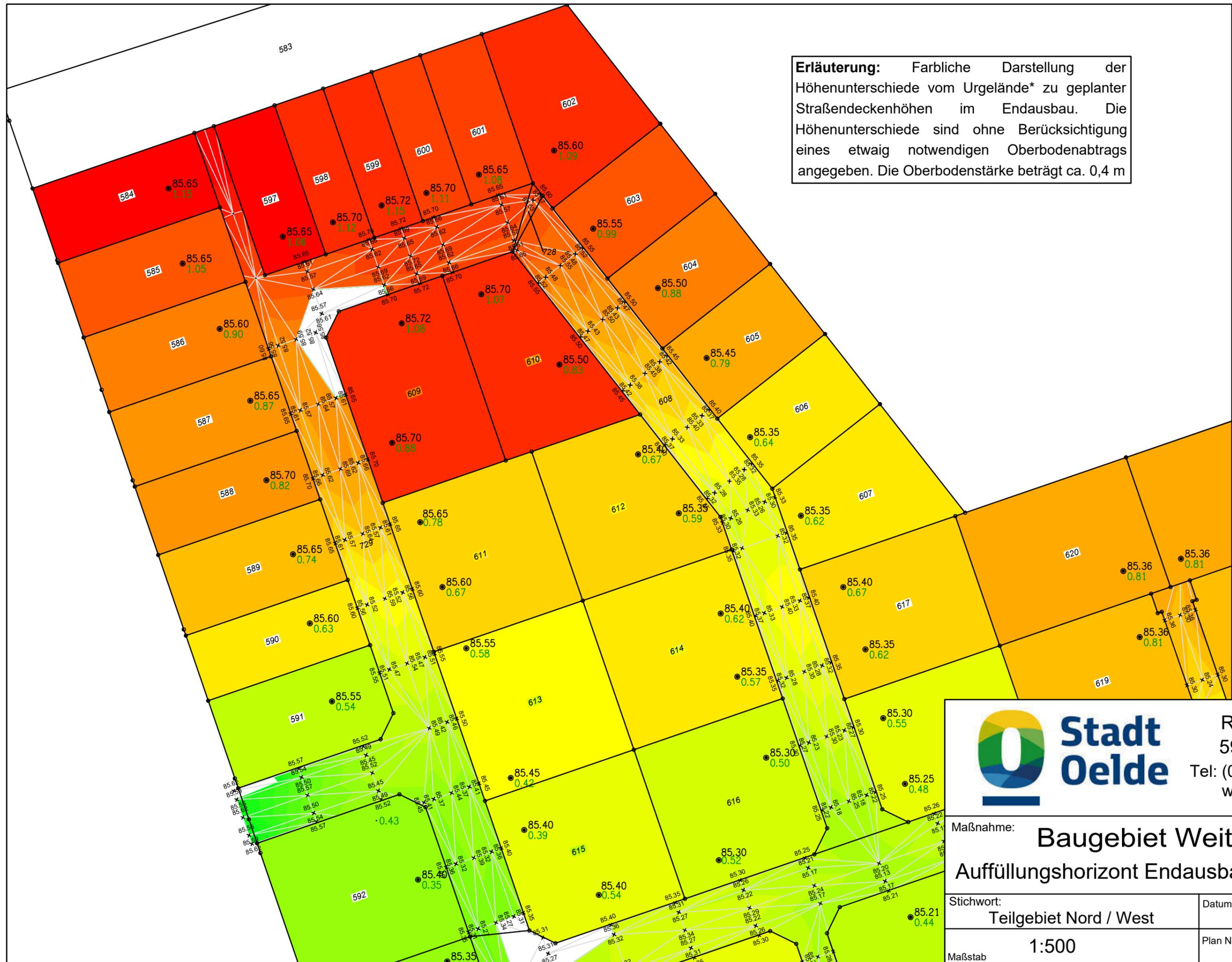
**Erläuterung:** Farbliche Darstellung der Höhenunterschiede vom Urgelände\* zu geplanter Straßendeckenhöhen im Endausbau. Die Höhenunterschiede sind ohne Berücksichtigung eines etwaig notwendigen Oberbodenabtrags angegeben. Die Oberbodenstärke beträgt ca. 0,4 m
